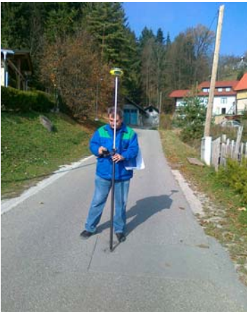
Izmera hišnega zaklopnika z GNSS
