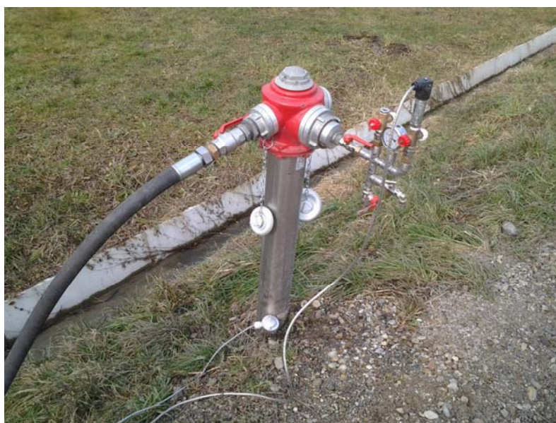
Slika prikazuje merilno napravo za merjenje tlaka, merilno napravo za merjenje temperature.
