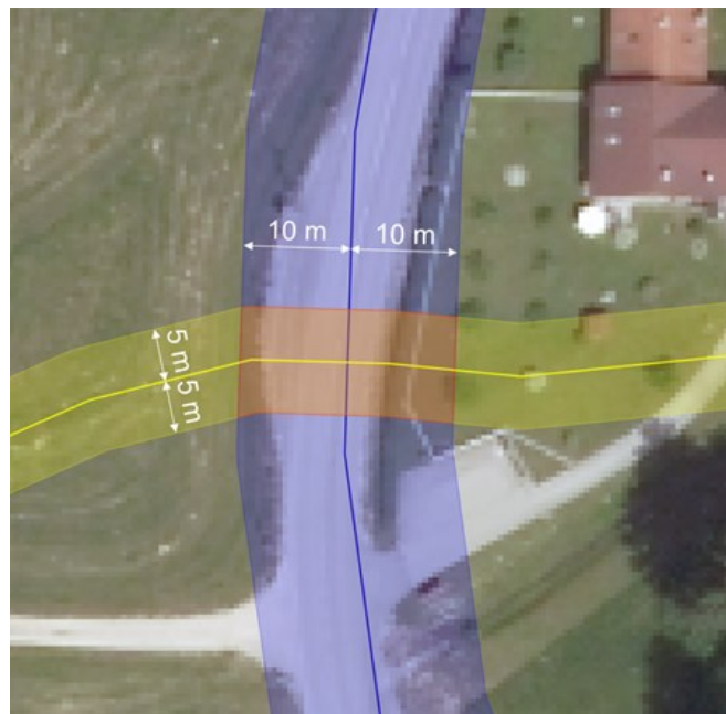
Levo: prikaz vodov v GIS. Desno: prikaz vodov s prikazom mogočih položajev posameznega voda.
